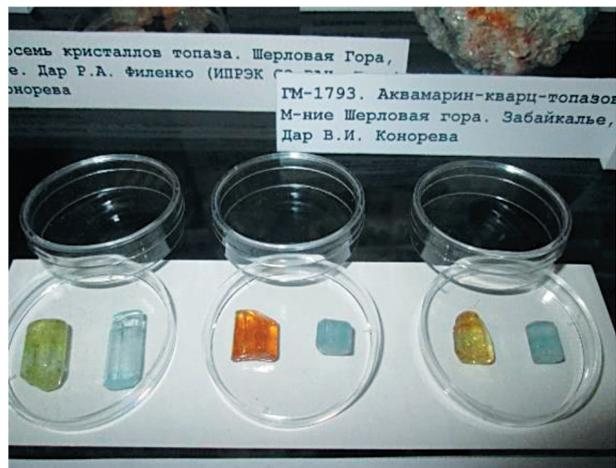
Рис. 5. Аквамарины (справа), полученные методом автоклавной обработки желто-зеленых бериллов (слева). T–500 °С, P–1000 атм, H<sub>2</sub>O+10% H<sub>2</sub>
