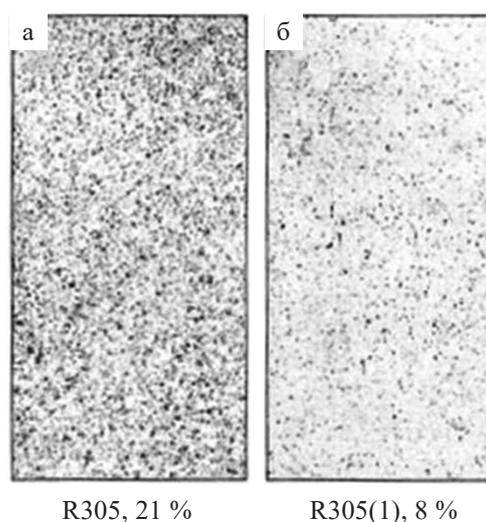
Сканограммы плавленных блоков кварца из необработанной (а) и обработанной (б) плазмой крупки
